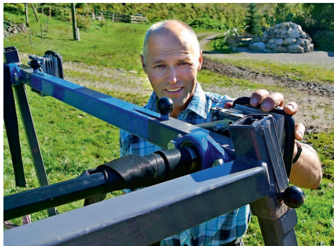
Der Motor treibt über eine starke Untersetzung die Welle an, wo sich die schwarzen Gurten aufwickeln und die Kuh langsam hochzieht.
