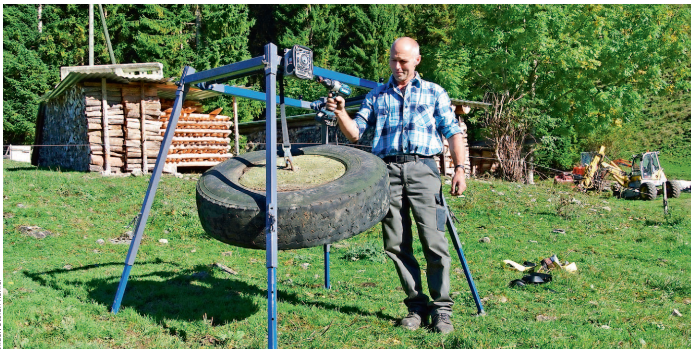
Peter Studer demonstriert die Stabilität seines Kuhliffts. Ein 500 kg schwerer Betonklotz wird nahe einem Standbein angehoben. Die ganze Konstruktion ist standfest und die Kraft des Akkubohrers allein reicht, um das schwere Gewicht anzuheben.
