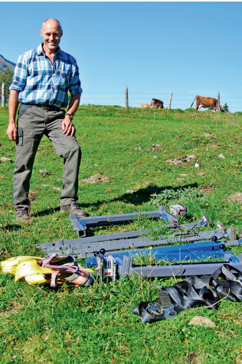
Peter Studer mit dem Kuhlift vor der Installation. Der Lift ist insgesamt 70 kg schwer und hat auf dem Vordersitz eines Autos Platz.
