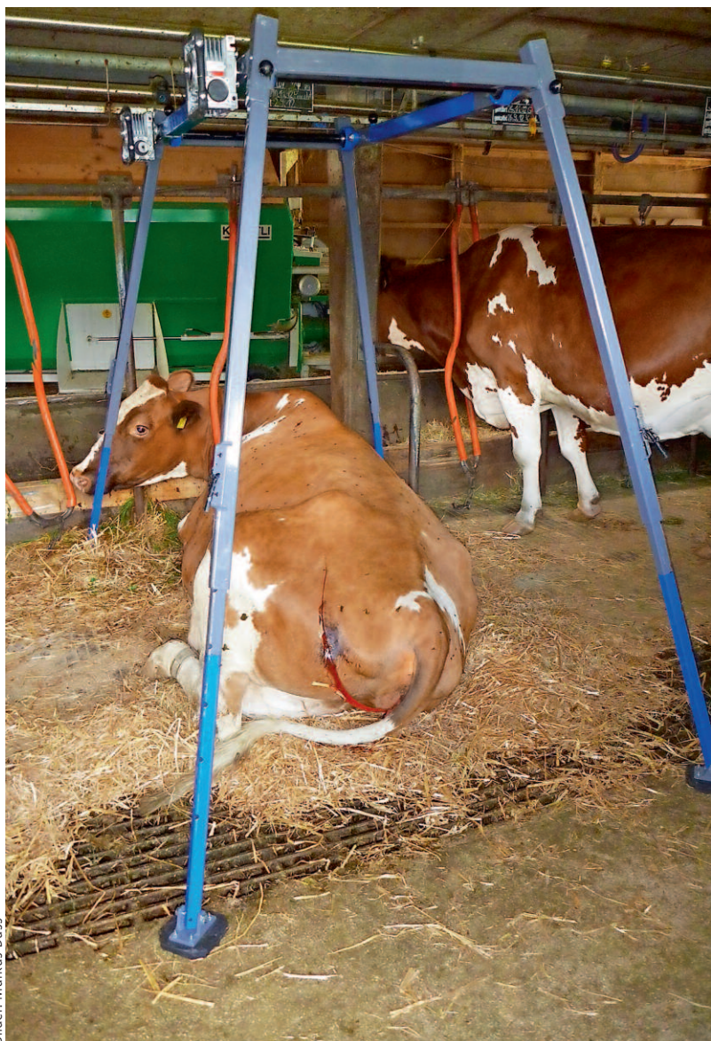
Der Prototyp von Peter Studers Kuhliften hat sich in der Praxis bereits bewährt. Der Lift wird über der festliegenden Kuh aufgebaut . . .
