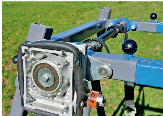
Das Herzstück des Kuhliffts: Ein Schneckengetriebe mit hoher Untersetzung sorgt dafür, dass die Gurten nicht abrollen können.
